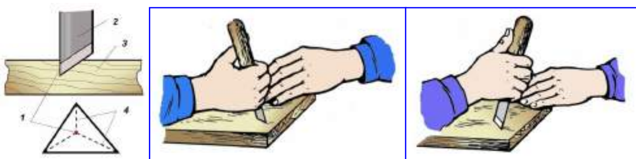
Рис. 2. 15. Різці для виконання геометричного різьблення
